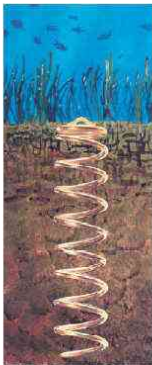
Figura 8.10. Tipología de anclajes Harmony tipo P.
