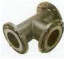
El espesor de pared mínimo será  $K=12$ , excepto las Tes que será como mínimo de  $K=14$ . El revestimiento tanto exterior como interior se hará con pintura bituminosa de forma que el espesor medio de la capa no sea inferior a  $70 \mu\text{m}$ .
